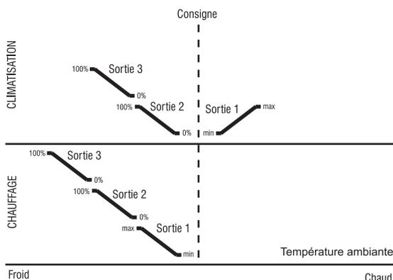
Lorsque le numéro 5 est sélectionné, la sortie 3 contrôle le chauffage ou la climatisation selon si le mode par défaut est placé sur chauffage ou climatisation respectivement (voir section 4.3.1). Par exemple, si le mode par défaut est le mode chauffage, le contact reste ouvert lorsque le thermostat est en mode climatisation. Lorsque le thermostat est en mode chauffage, le contact se ferme lorsque la sortie 1 atteint le seuil réglé (voir la section 4.1).
