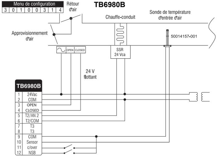
**FIGURE 4 :** Contrôle de température de l'approvisionnement d'air frais
