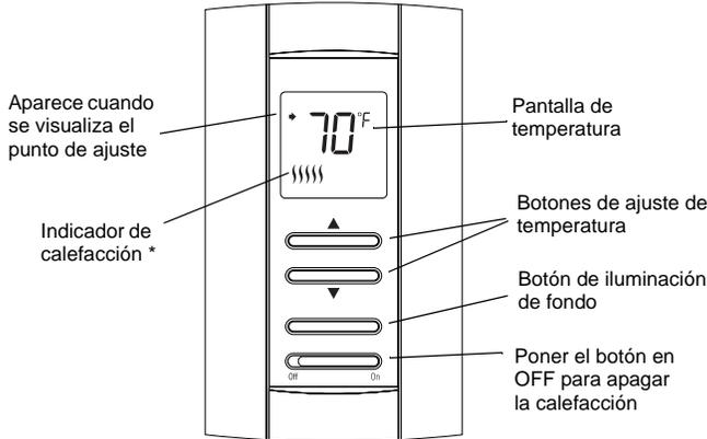
\* El termostato indica qué porcentaje de calefacción se requiere para mantener la temperatura deseada. Por ejemplo, aparece el símbolo cuando la calefacción está al 40% de su potencia.
