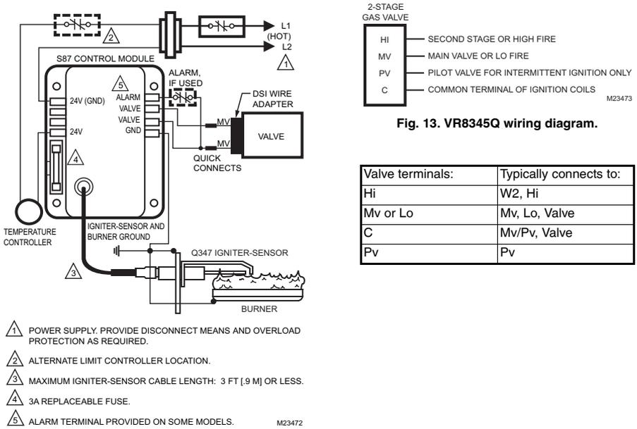
**Fig. 13. VR8345Q wiring diagram.**
