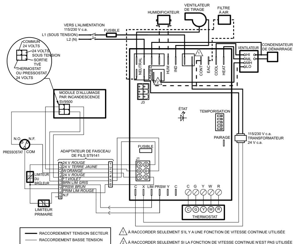
Fig. 4. Schéma de raccordement type du ST9120B,U dans un système ST9141 avec régulateur SmartValve<sup>MC</sup> SV9500/SV9501.
