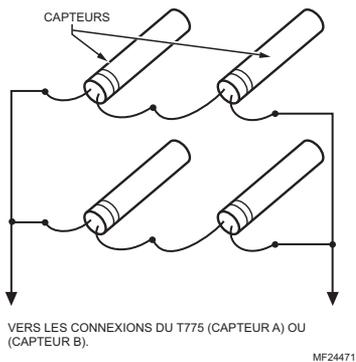
**Fig. 3. Raccordement de capteurs en séries parallèles.**
