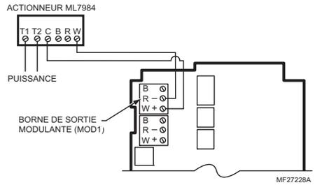
Fig. 15. Raccordement d'un actionneur de vanne ML7984 (utilisant un signal de 4 à 20 mA).
