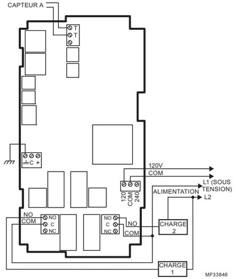
Fig. 10. Raccordement électrique d'un régulateur à deux étages - 120 (entrée de 120 V c.a. et charge de 120 V c.a. illustrées).
