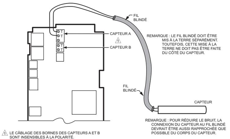
⚠ LE CÂBLAGE DES BORNES DES CAPTEURS A ET B SONT INSENSIBLES À LA POLARITÉ.
