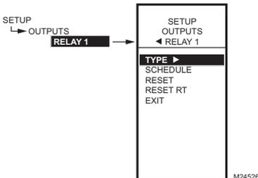
Fig. 64. Configurations - Sortie - Menu des relais.
