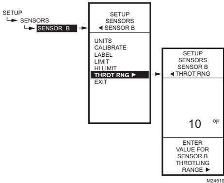
Fig. 46. Configuration - Capteurs - Capteur B - Bande proportionnelle.
