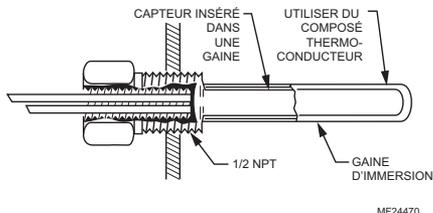
Fig. 2. Capteur inséré dans une gaine d'immersion.
