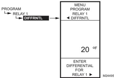
Fig. 31. Programmation - Différentiel ou bande proportionnelle.
