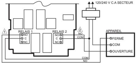
⚠ FERMER LE RELAIS POUR FERMER L'APPAREIL. RELAIS 1 ILLUSTRÉ. (LES RELAIS 1 ET 3 SERVENT À LA FERMETURE).
