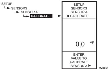
Fig. 40. Configuration - Capteurs - Capteur A - Étalonnage.
