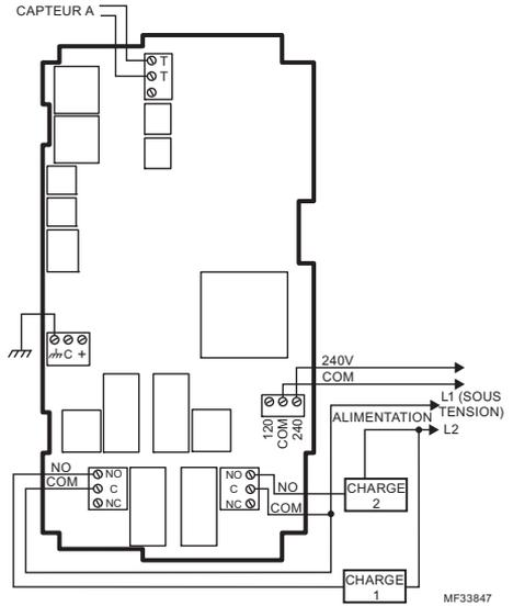
Fig. 11. Raccordement électrique d'un régulateur à deux étages - 240 V c.a.
