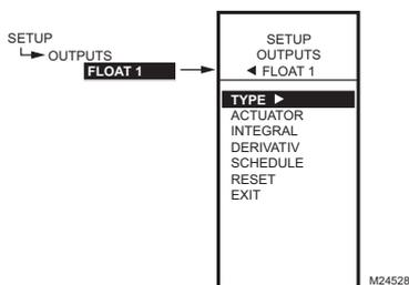
Fig. 66. Configuration - Sorties - Relais flottants - Menu.
