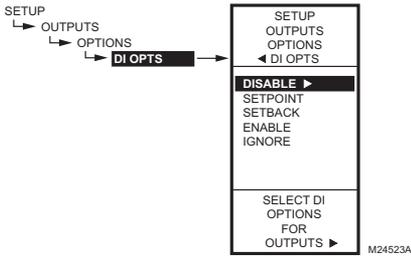
Fig. 60. Configuration - Sorties - Options - Options de l'entrée numérique.
