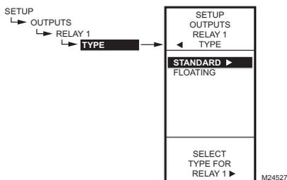
Fig. 65. Configuration - Sorties - Relais - Type.
