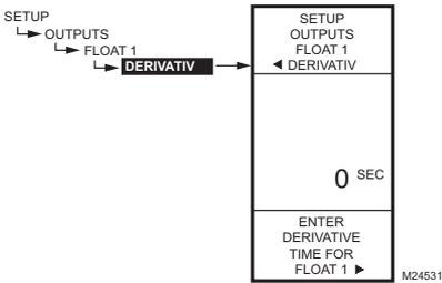
Fig. 69. Configuration - Sorties - Relais flottants - Dérivée.
