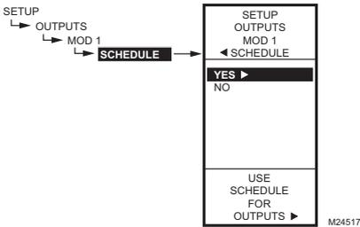
Fig. 53. Configuration - Sorties - Sortie modulante - Horaire.
