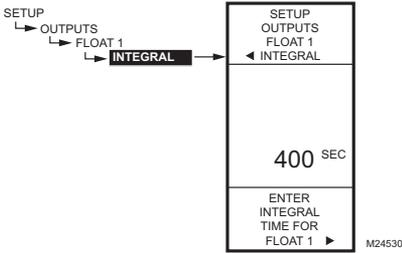
Fig. 68. Configuration - Sorties - Relais flottants - Intégrale.
