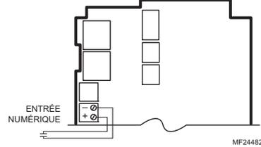
Fig. 16. Raccordement d'une entrée numérique (contact sec).
