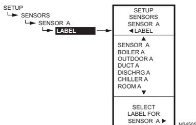
Fig. 41. Configuration - Capteurs - Capteur A - Étiquette.
