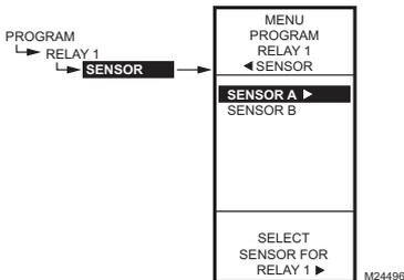
Fig. 32. Programmation - Capteur.
