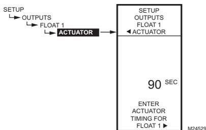
Fig. 67. Configuration - Sorties - Relais flottants - Actionneur.
