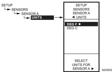
Fig. 39. Configuration - Capteurs - Capteur A - Unité de mesure.
