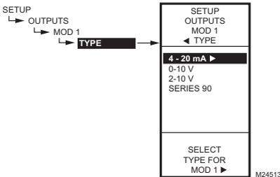
Fig. 49. Configuration - Sorties - Sortie modulante - Type.
