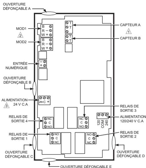
⚠ LES CAPTEURS A ET B UTILISENT LES DEUX CONNEXIONS TT ET SONT INSENSIBLES À LA POLARITÉ.
