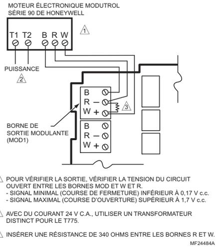
**Fig. 19. Raccordement d'un moteur Modutrol série 90.**
