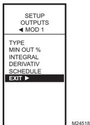
Fig. 55. Configuration - Sorties - Sortie modulante - Quitter.
