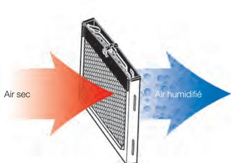
Dans un appareil à tampon d'évaporation, l'énergie est absorbée par l'air et doit ensuite être rétablie par le système de chauffage, qui transforme le gaz en chaleur.
